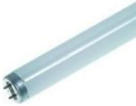
المصباح الفلوري أداة في شكل أنبوب تنتج ضوءاً كهربائياً تستعمل على نحو واسع في المصانع والمكاتب والمدارس. والمصايبح المتوهجة أكثر استعمالاً في المنازل من المصايبح الفلورية. ويستهلك المصباح الفلوري من الكهرباء حوالي خمس ما يستهلكه المصباح المتوهج لإعطاء نفس كمية الضوء. وهو أيضاً ينتج خمس ما ينتج من حرارة، مع مقدار الضوء نفسه. وللهذا السبب، تسمى المصايبح الفلورية أحياناً الأضواء الباردة. وفضلاً عن ذلك، تعيش المصايبح الفلورية لمدة أطول بكثير من المصايبح المتوهجة.
